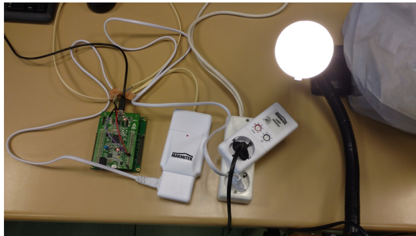
Figura 63: Montaje para el ensayo de la comunicación
