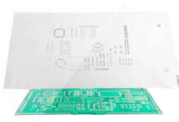
Figura 44. Plantilla o Stencil para facilitar la soldadura SMD.
