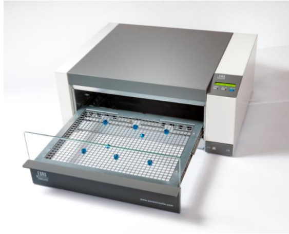
Figura 45. Horno programable para soldadura SMD.
