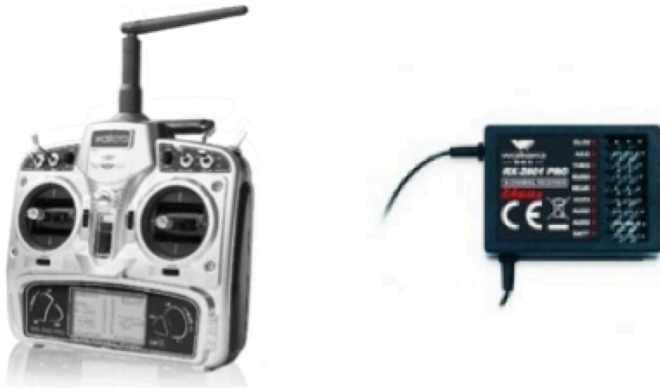
Figura 3.27. Emisora Walkera WK-2801 PRO (izquierda) y su receptor (derecha).
