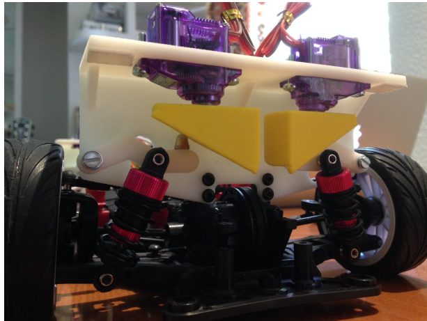
Figura 2. Sistema de amortiguación activa delantero instalado.
