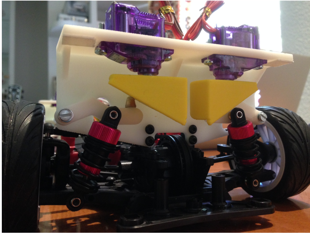
Figura 2.4. Sistema de suspensión activa delantero instalado.
