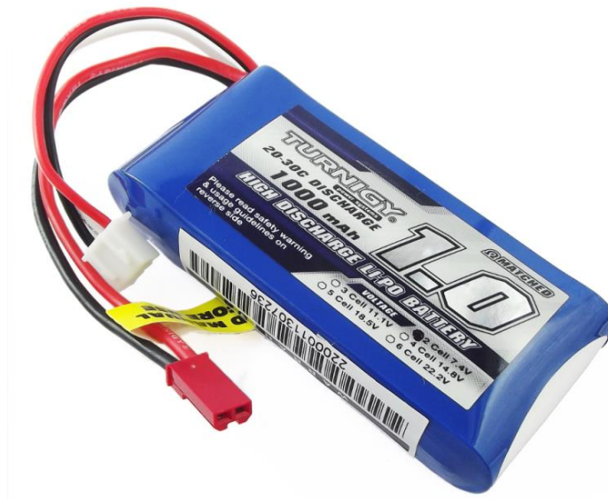
Figura 3.5. Batería LiPo para alimentar el cuadricóptero.
