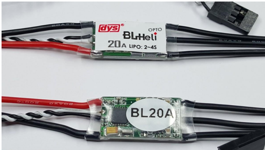
Figura 3.3. Detalle de los ESCs DYS BL-Heli 20A.
