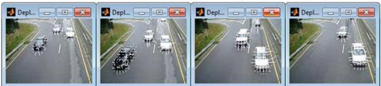
Figura 5.3. Detección de objetos móviles en una serie de tramas usando flujo óptico.
