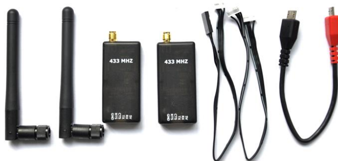
Figura 3.16. Emisoras 3DR para enlace con Simulink
