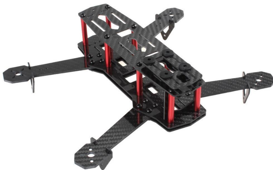
Figura 3.1. Estructura ZMR250 del cuadricóptero.
