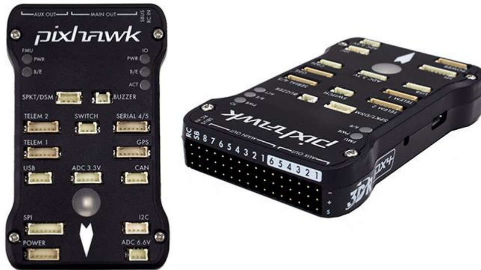
Figura 3.7. Tarjeta de control Pixhawk PX4 FMU.
