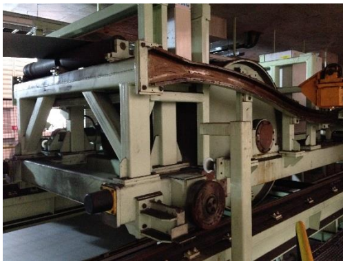
Figura 9: Extremo móvil del bucle, consistente en un rodillo apoyado en una plataforma que desliza por unos raíles (izquierda).
