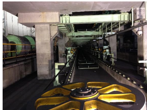
Figura 9: Extremo móvil del bucle, consistente en un rodillo apoyado en una plataforma que desliza por unos raíles (izquierda).
