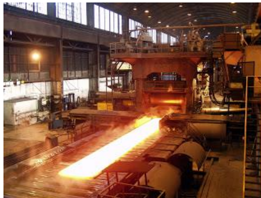
Figura 7: Laminación en caliente en una fábrica de acero inoxidable
