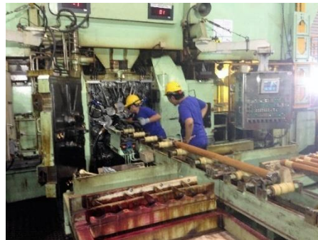
Figura 18: Cambio de rodillos de trabajo en un Sendzimir
