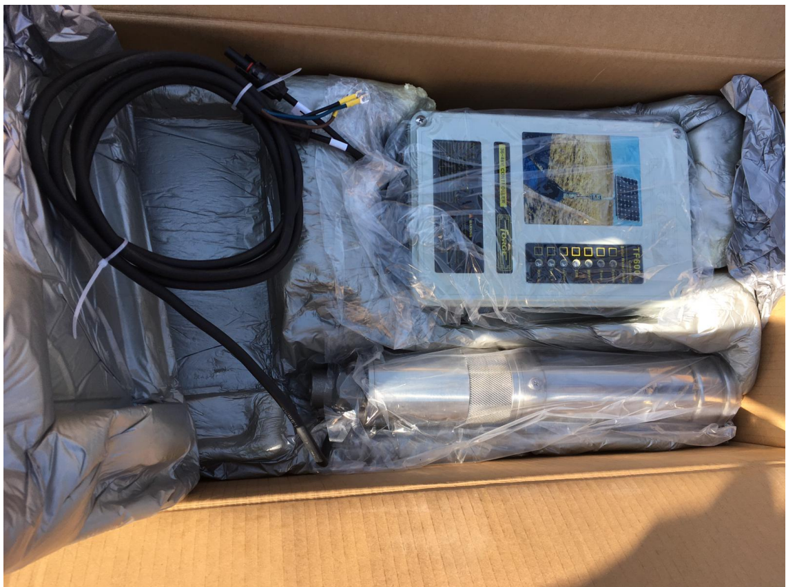
Ilustración 20. Contenido del pack de bombeo solar (Sensores, regulador de carga y bomba). Fuente: propia
