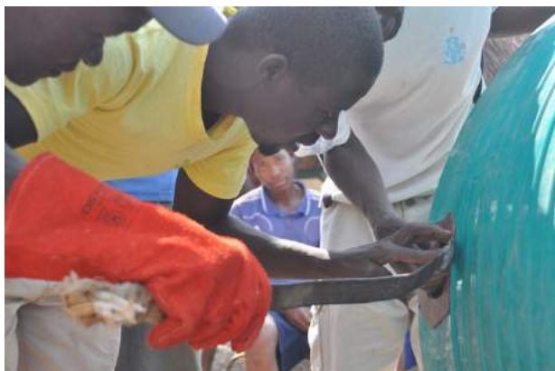
Ilustración 30. Refuerzo de los agujeros derritiendo plástico. Fuente: Manuel Moreno.
