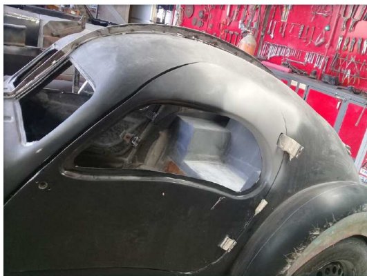
Figura 57: Aplicación masilla (Fuente: Gaamacars)
