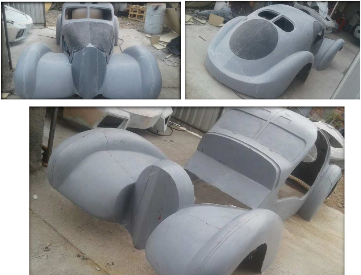
Figura 49: Molde acabado (Fuente: Gaamacars)
