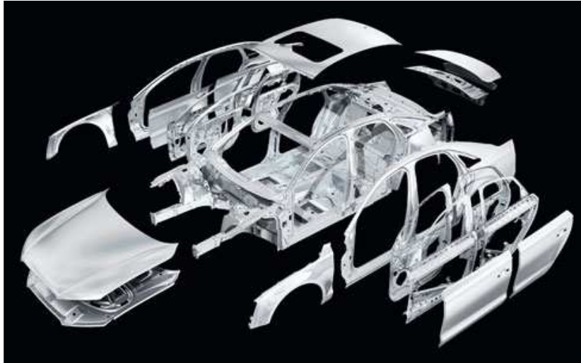
Figura 11: Carrocería autoportante (Fuente: wordpress.com)
