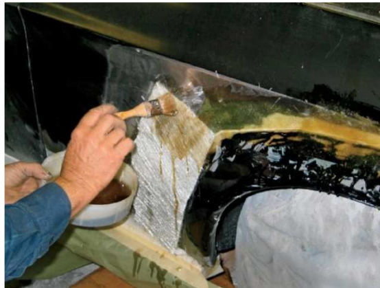
Figura 54: Aplicación Fibra de vidrio (Fuente: Gaamacars)
