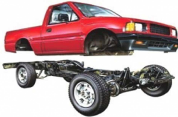
Figura 9: Chasis con carrocería separada (Fuente: "Técnicas del automóvil CHASIS" José Manuel Alonso Pérez)
