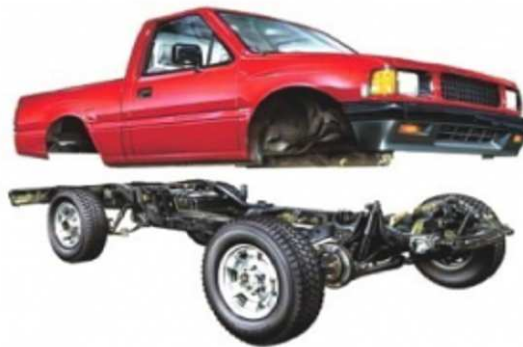
Figura 2: Chasis con carrocería separada (Fuente: "Técnicas del automóvil CHASIS" José Manuel Alonso Pérez)
