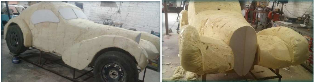
Figura 45: Aplicación de espuma expansiva (Fuente: Gaamacars)
