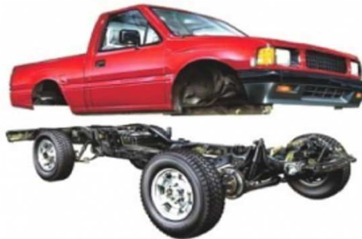
Figura 5: Chassis with independent body (Fuente: "Técnicas del automóvil CHASIS" José Manuel Alonso Pérez)
