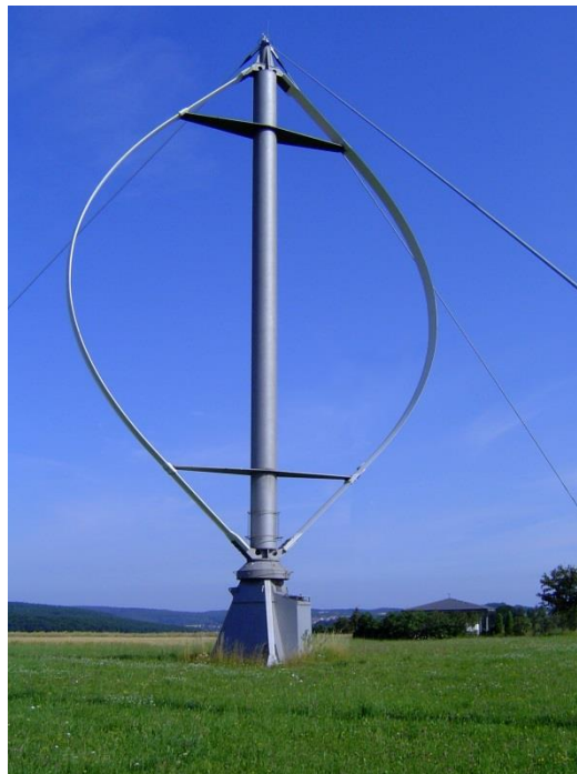
Figura 2. Aerogenerador de eje vertical de tipo Darrieus.
