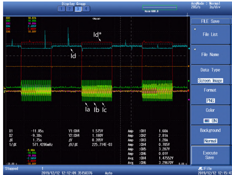
Figura 7.4: Corrientes trifásicas por las bobinas con referencia de eje corriente de eje d en forma de pulsos. Referencia de I_q = 0 . La identificación de las señales se muestra en detalle en la figura.
