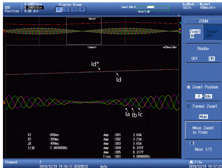
Figura 7.6: Detalle de las corrientes trifásicas por las bobinas con referencia de eje corriente de eje d en forma senoidal de 4Hz. La identificación de las señales se muestran en detalle en la figura. Referencia de I_q = 0 .
