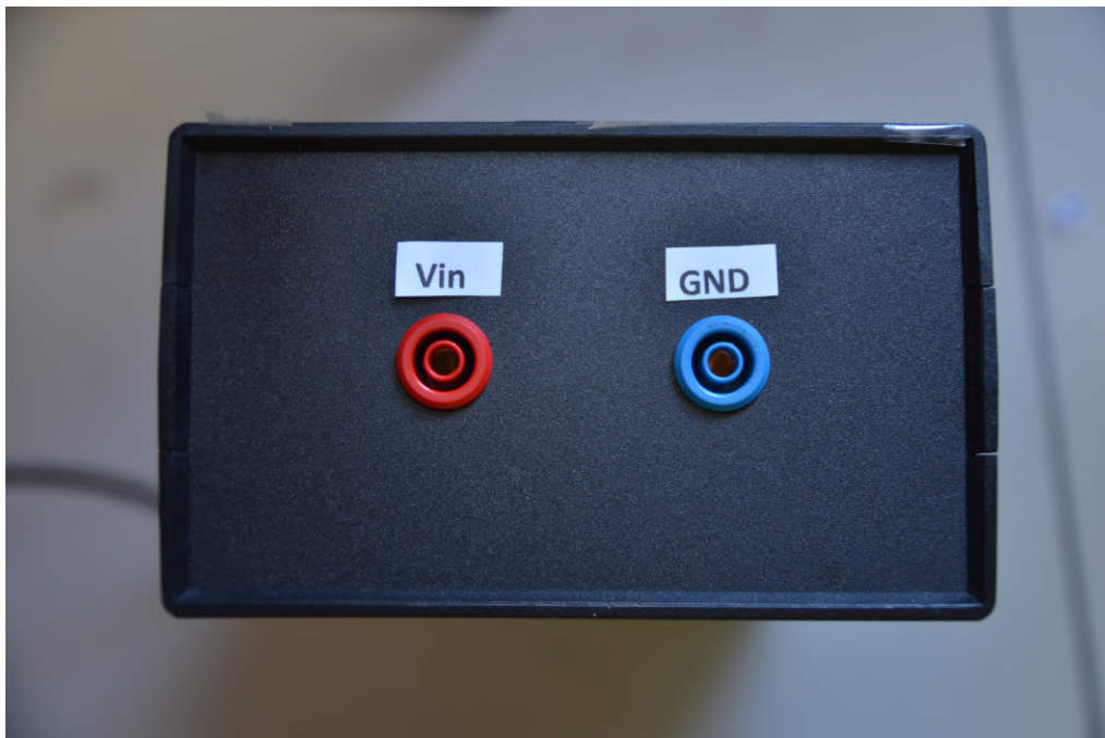
Figura 6.26: Encapsulado del VSC y Launchpad. Entrada de tensión continua.
