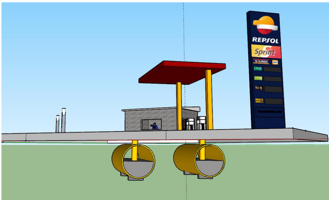
Figura 5: Posición de los tanques de combustible, sin cubetos. Pr.: SketchUp, Realización propia
