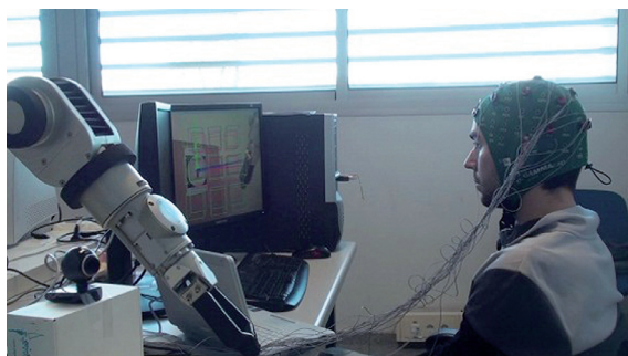
Figura 3. Prototipo brazo robótico controlado por actividad cerebral.
