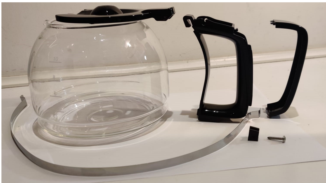
Ilustración 26. Jarra, tapa, asa, banda metálica, tornillo phillips y soporte banda
