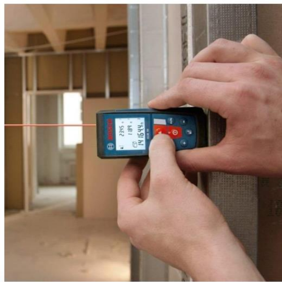
Figura 11: Medida de distancia con sensores láser [18]
