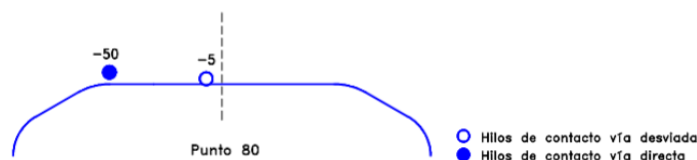
Figura 80 Pantógrafo en el punto de aguja 80. Aguja tangencial. [ADIF01]
