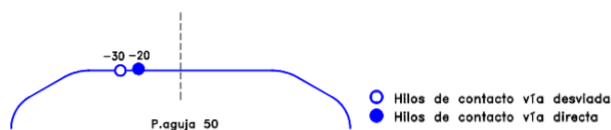
Figura 67 Pantógrafo en el punto de aguja 50. Aguja cruzada. [ADIF01]
