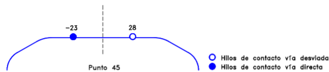
Figura 78 Pantógrafo en el punto de aguja 45. Aguja tangencial. [ADIF01]
