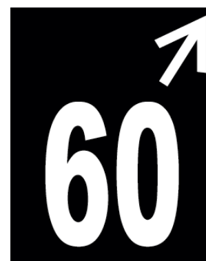
Figura 25. Indicadora de posición de agujas a vía desviada y velocidad de paso [6]
