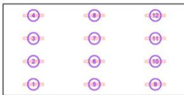
Figura 17: Distribución de las luminarias en la biblioteca.
