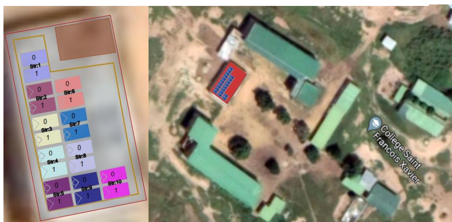
Figura 52: Localización de instalación de los paneles fotovoltaicos.
