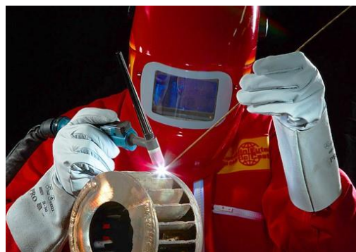
Imagen 96: Soldador Realizando una Soldadura TIG
