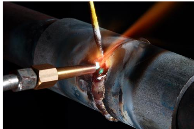
Imagen 90: Ejemplo de Soldadura Fuerte
