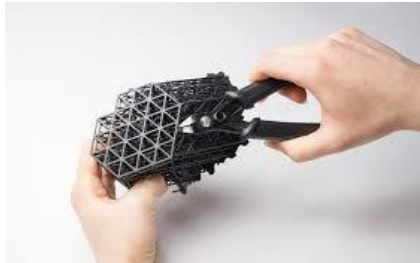
Imagen 79: PostProcesado de Filamentos Plásticos
