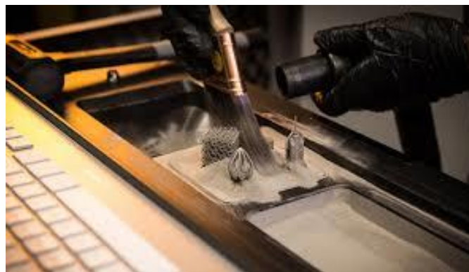
Imagen 80: PostProcesado de Polvo Polimérico Usando un Aspirador
