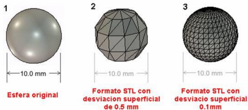
Imagen 70: Calidad de la Pieza según la Desviación Superficial elegida
