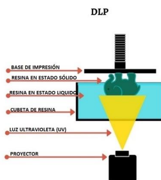
Imagen 61: Esquema del Proceso DLP
