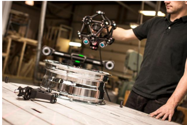
Imagen 84: Operario Realizando un Escaneo 3D de una llanta de Neumático
