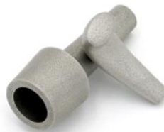
Imagen 82: Pieza Obtenida por 3DP y Agujerada con un Taladro
