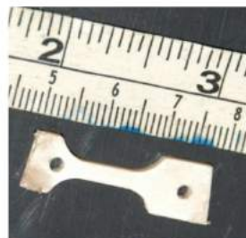
Ilustración 3: Probeta mecanizada. Subit et al.(2011)
