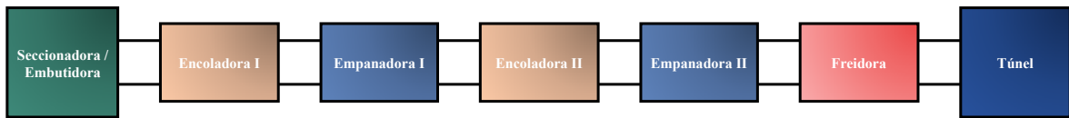
Figura 7. Secuencia de máquinas en la cabecera de la Línea 3.
