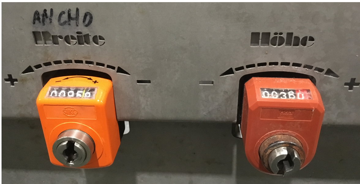
Ilustración 10. Llaves para ajustar la cerradora de estuches.
