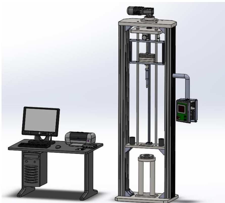
Ilustración 6: Disposición del equipo para ensayos por impacto de polímeros y materiales compuestos
