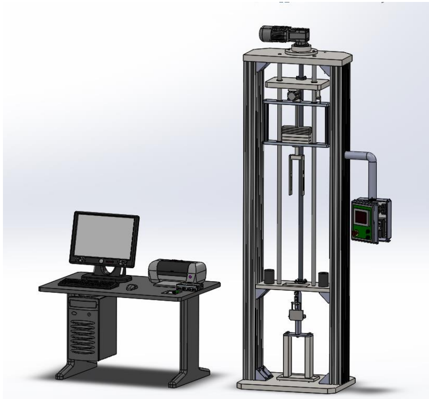
Ilustración 7: Disposición del equipo para ensayos por impacto de adhesivos para uniones metálicas
