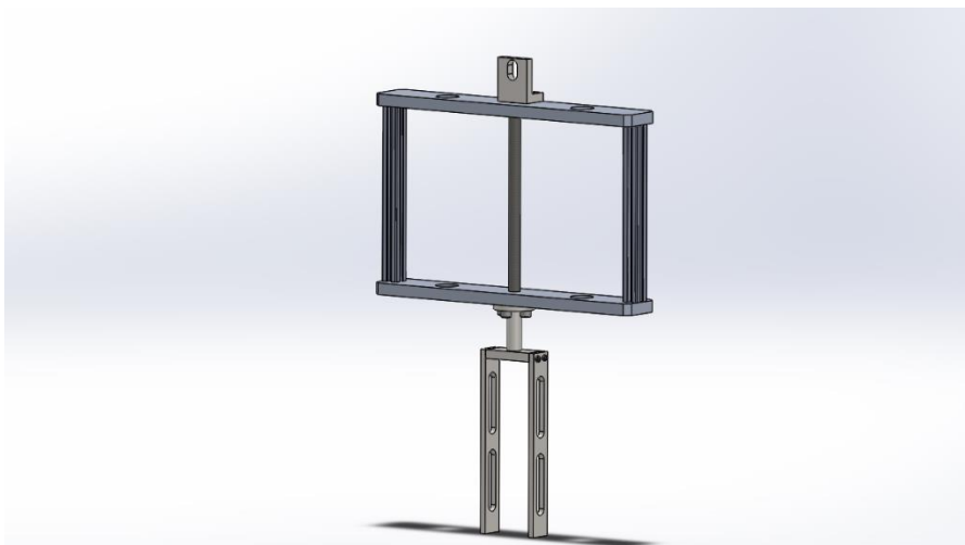
Figura 19: Conjunto de masas para ensayo de adhesivos
