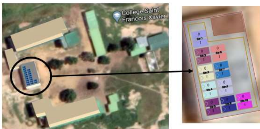
Ilustración 22. Disposición de los módulos en el techado del edificio de dirección
