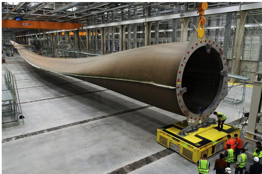
Ilustración 13: construcción pala aerogenerador - Fuente [24]
