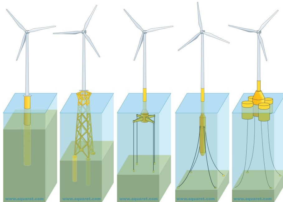
Ilustración 9: estrategias de anclaje de los aerogeneradores marinos – Fuente: [20]
