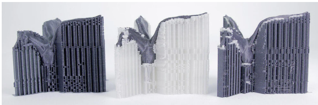
Figura 2.9: De izquierda a derecha: soporte sólido, soporte soluble, soporte mixto. Cortesía de Prusa Research
