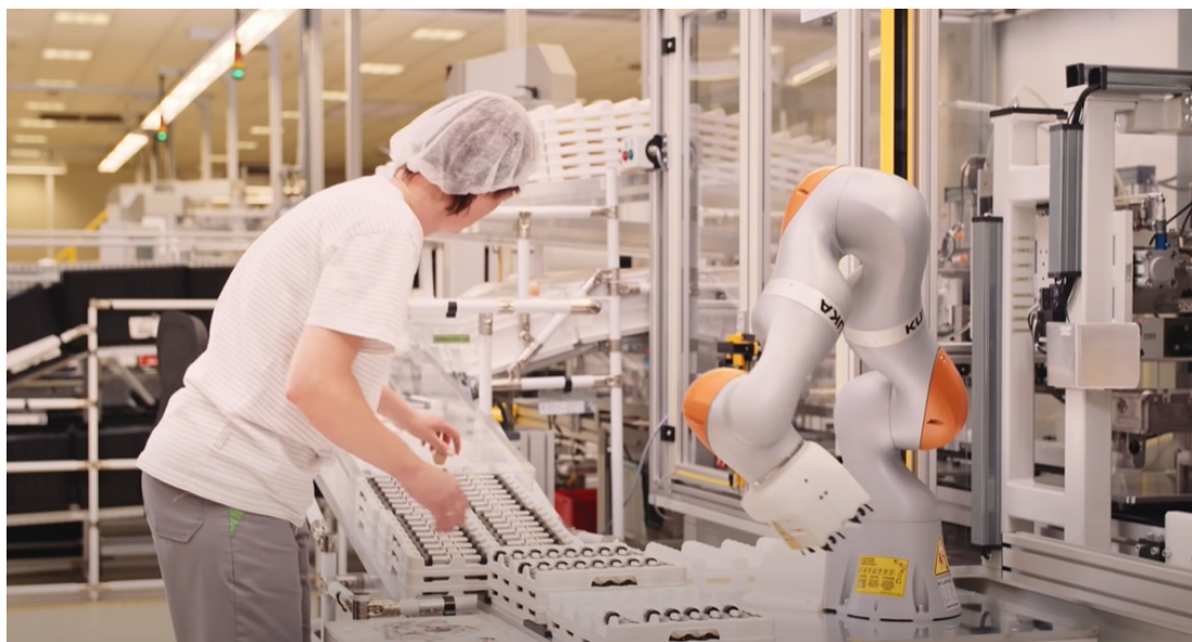
Figura 2.30: Robot KUKA compartiendo espacio de trabajo con operaria. Cortesía de KUKA Robotics
