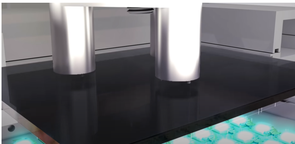
Figura 2.17: Captura del proceso MSLA, con la matriz de LEDs en la parte inferior. Cortesía de Structo 3D
