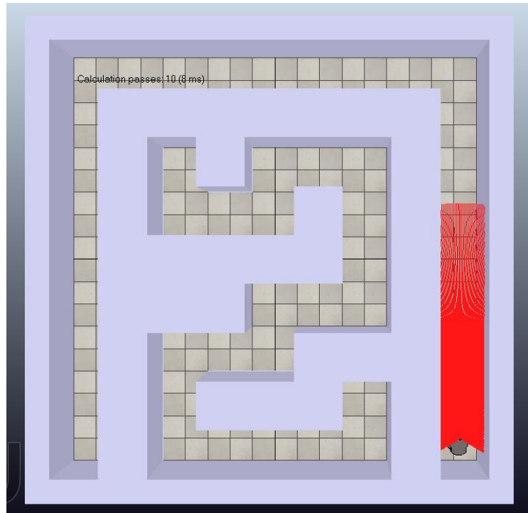
Figura 4.11 Entorno de simulación final funcionando (la zona roja se trata del área de visión del sensor)
