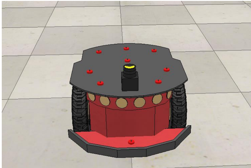
Figura 4.10 Pioneer P3-DX con sensor Hokuyo URG 04LX UG01_Fast acoplado
