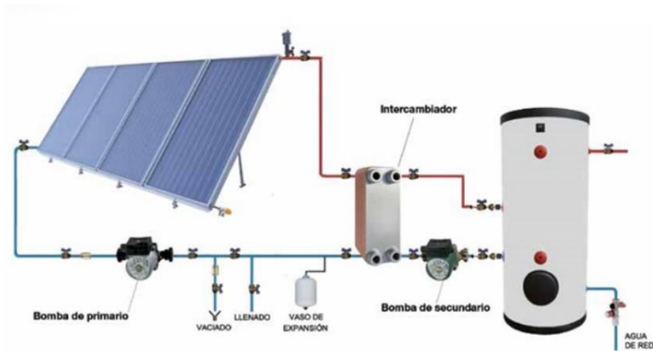
Esquema de la instalación térmica
