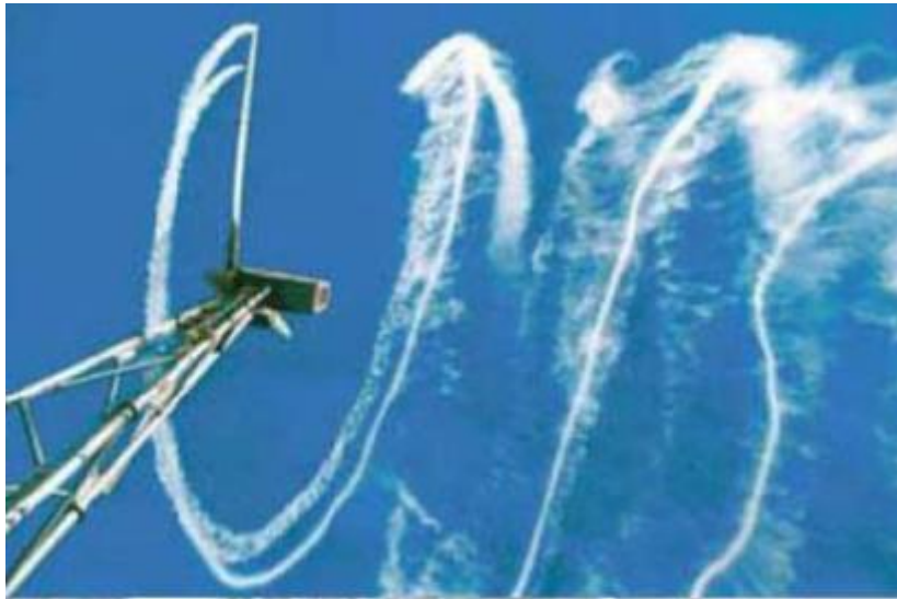
Ilustración 9: Efecto estela en un aerogenerador. Normalmente no se ve así, pero en este caso se añadió humo al aire para una mejor visualización.
