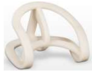
Ilustración 19: Útil fabricado mediante SL.
