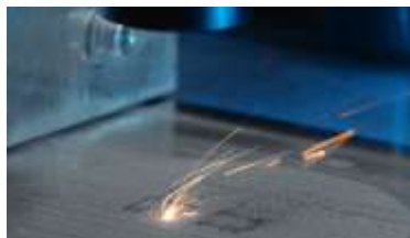
Ilustración 25: Proceso de fusión durante proceso SLM.
