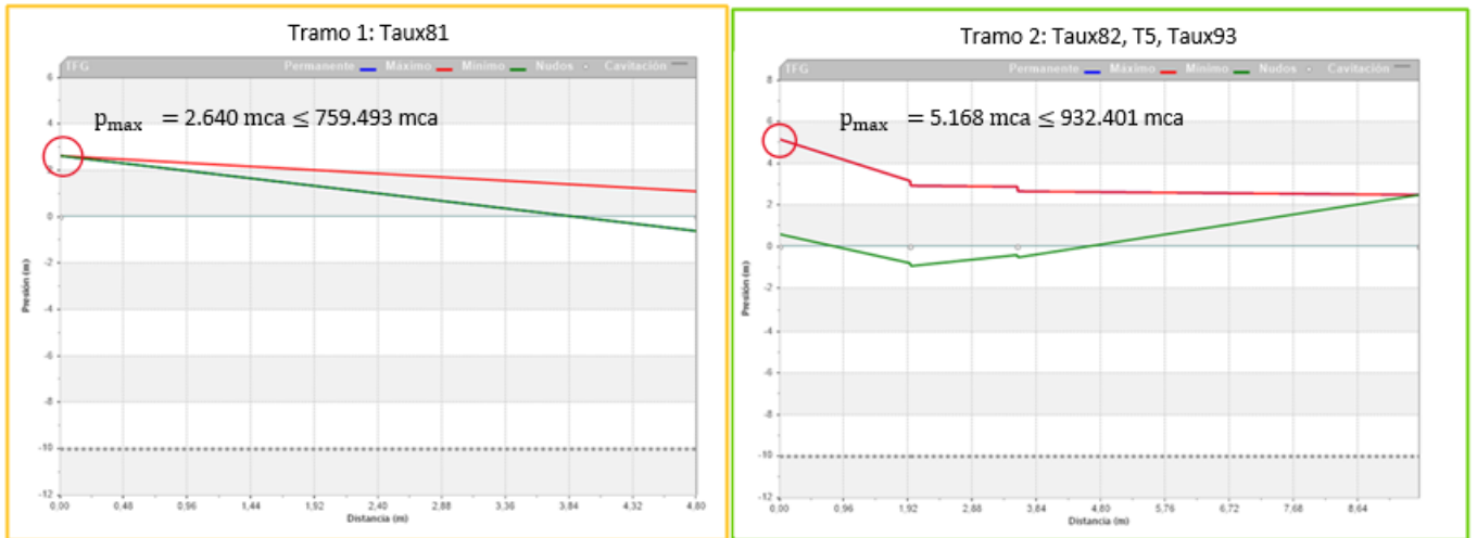
Figura 18. Régimen transitorio: Sobrepresiones, circuito 3, Turbina Kaplan con bomba Weise
