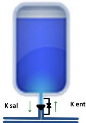
Figura 63. Calderín con bypass
