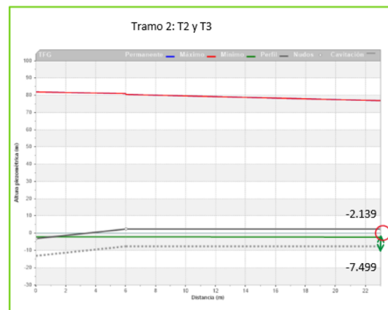
Figura 257. Régimen transitorio: Depresiones, circuito 4, Turbina Pelton con bomba sumergida
