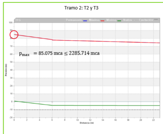
Figura 256. Régimen transitorio: Sobrepresiones, circuito 4, Turbina Pelton con bomba sumergida
