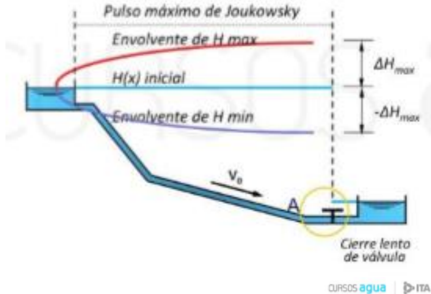
Figura 78. Envolvente cierre lento de una válvula
