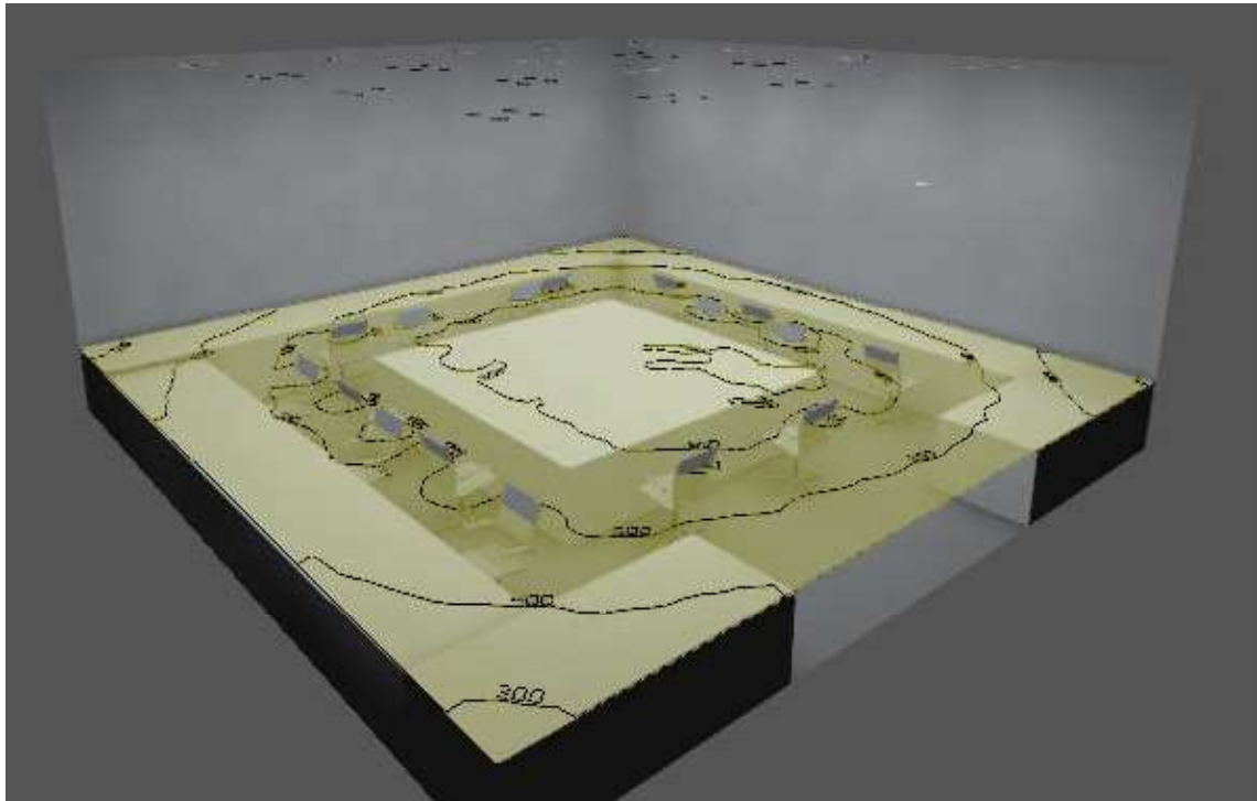
Figura 52. Representación en 3D de la iluminación general de la zona de trabajo. Diseño inicial
