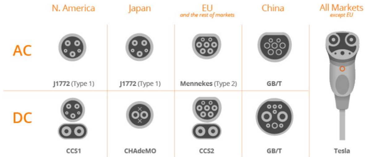
Figura 8: Conectores de VEs según localización y tipo de corriente [15]
