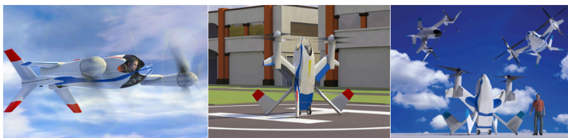
Figura 2: Recreaciones virtuales del funcionamiento del NASA Puffin. (NASA, 2010)
