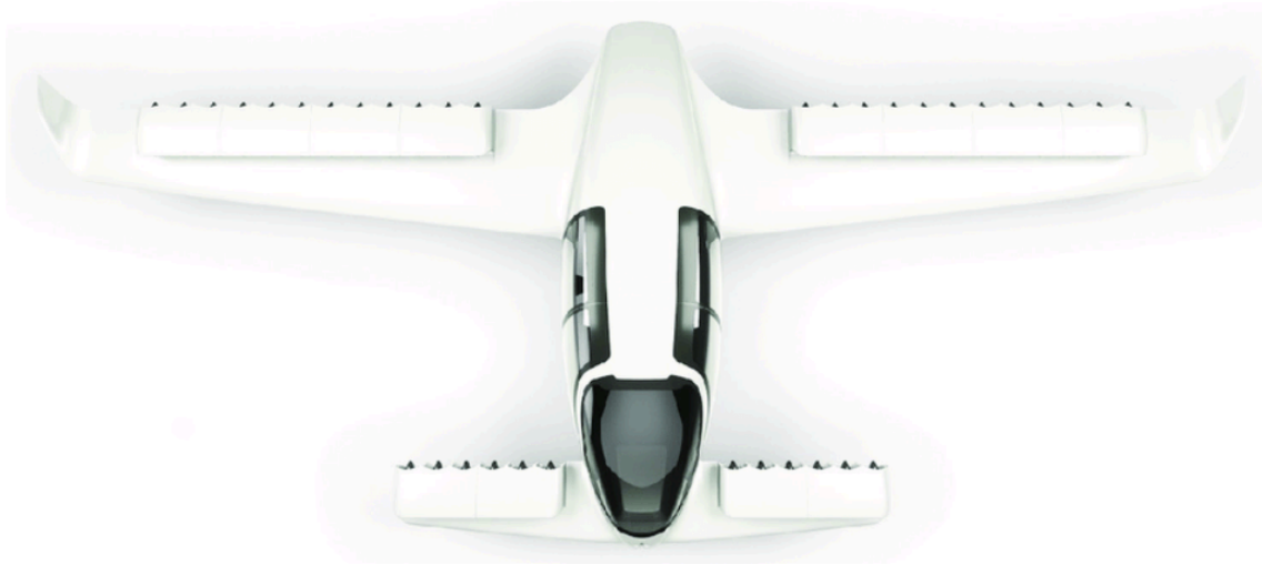
Figura 11: Vista de planta del modelo para cinco pasajeros de Lilium. (Bacchini & Cestino, 2019)
