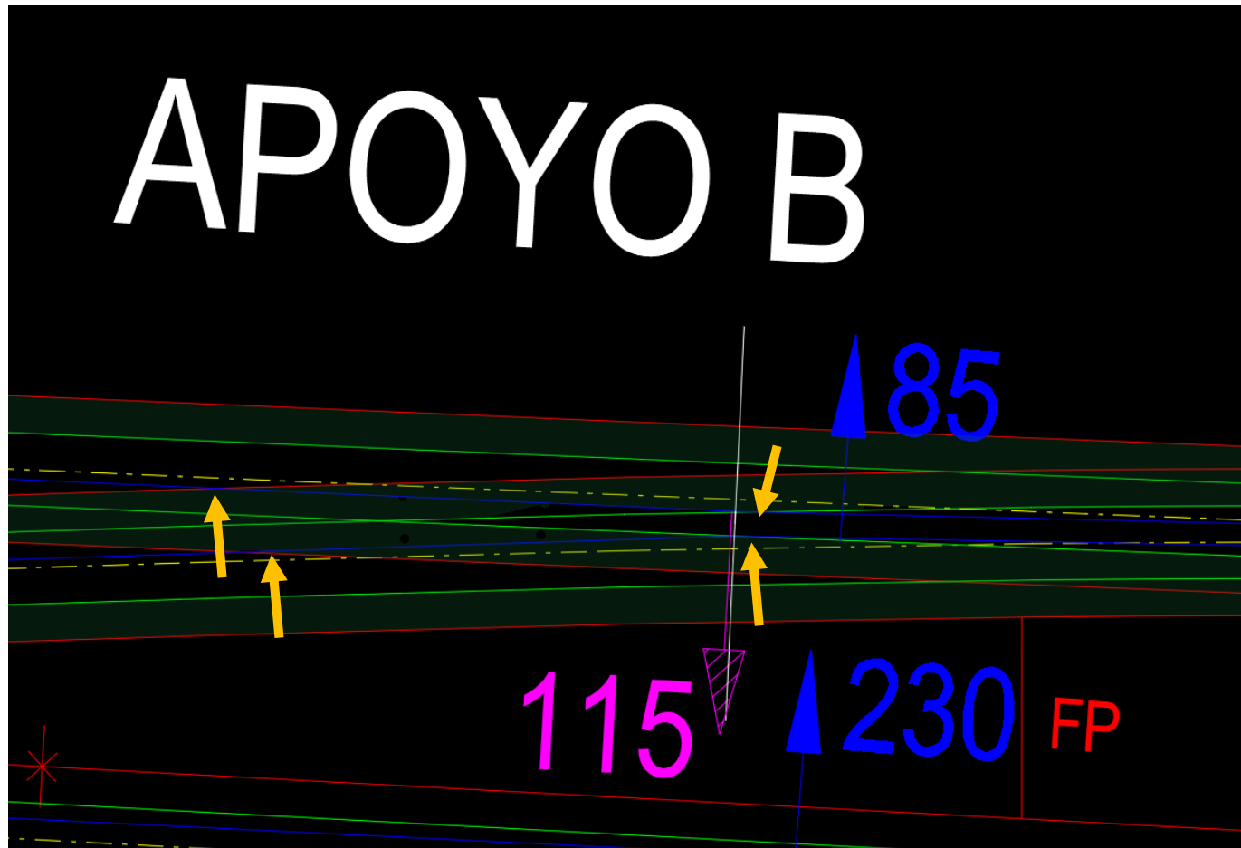
Ilustración 35 Estado final de los Hilos de Contacto en Apoyo B
