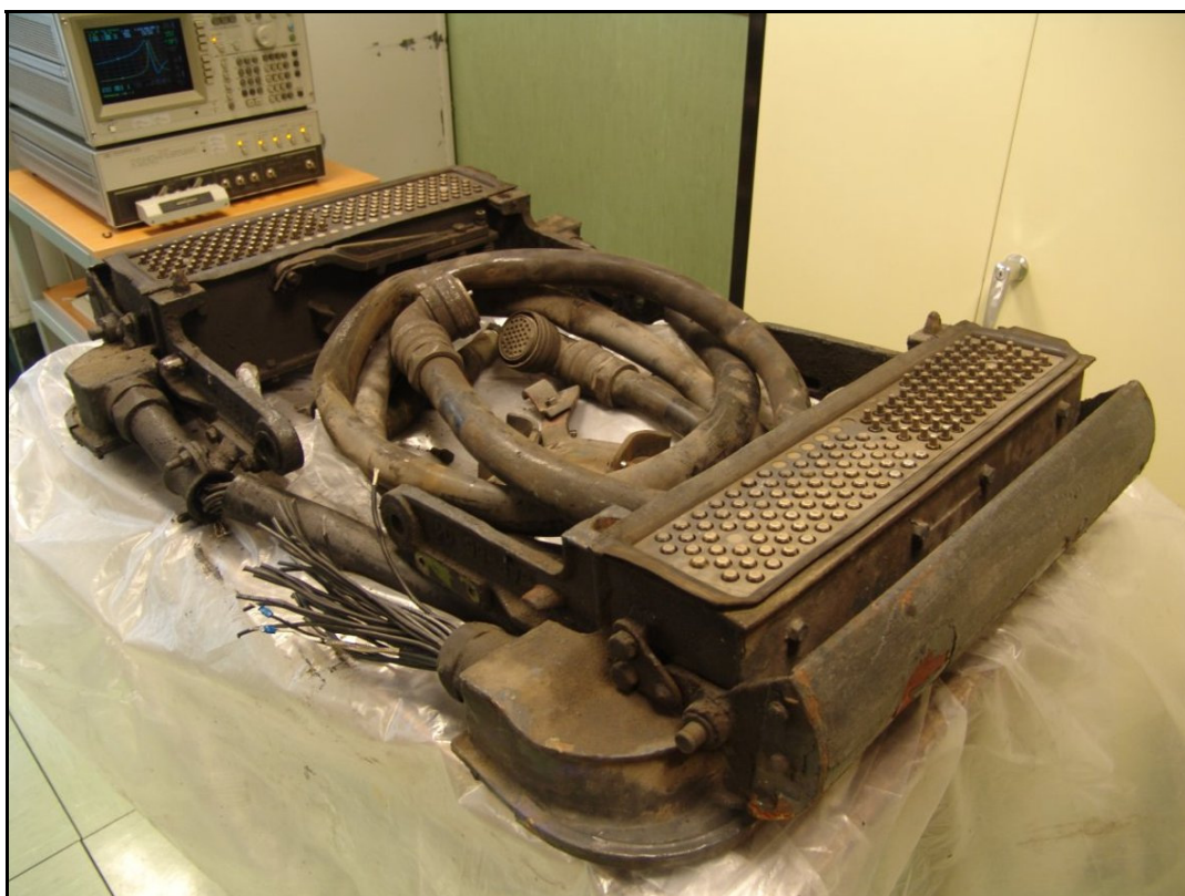
Figura B-17. Scharfenberg desacoplado.
