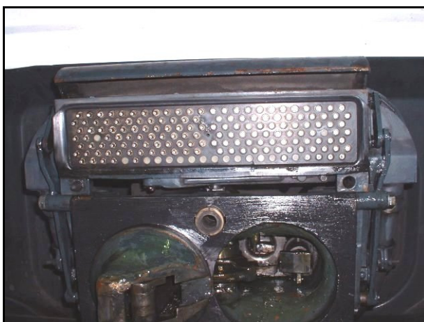
Figura 2-17. Vista frontal del Scharfenberg automático con la tapa protectora levantada.
