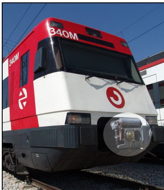
Figura 2-16. Localización del Scharfenberg automático en el tren.
