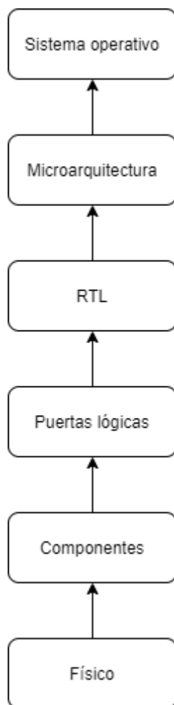
Figura 1. Niveles de abstracción de un sistema electrónico
