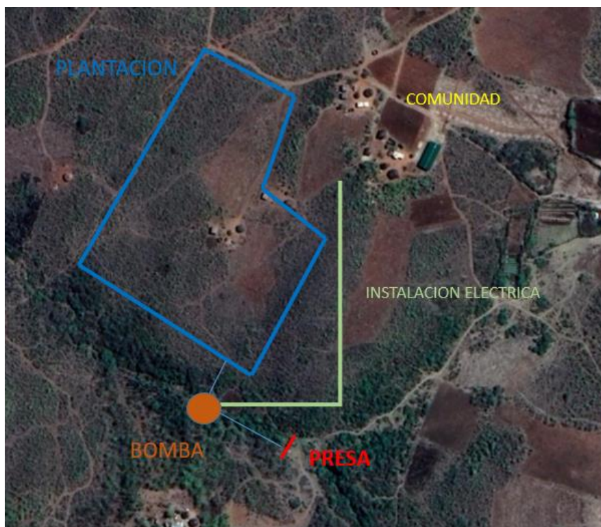
Figura 62. Plano final con instalación eléctrica
