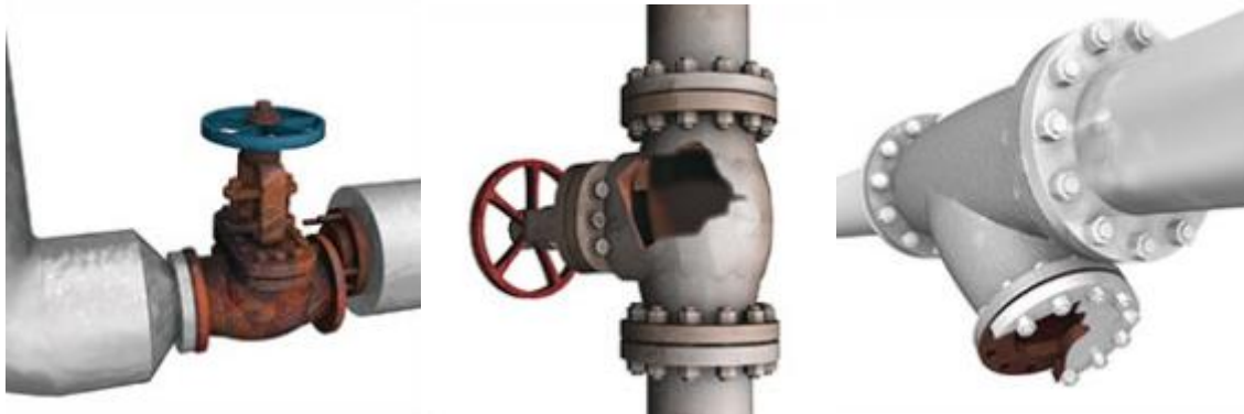
Figura 36. Posibles roturas debido a golpe de ariete
