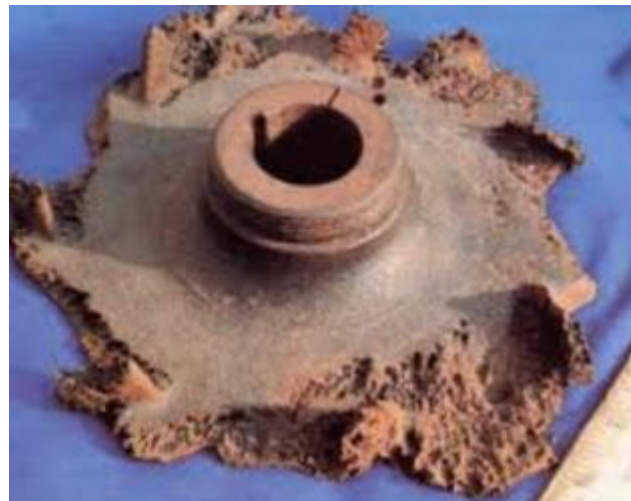
Figura 35. Rodete erosionado por cavitación
