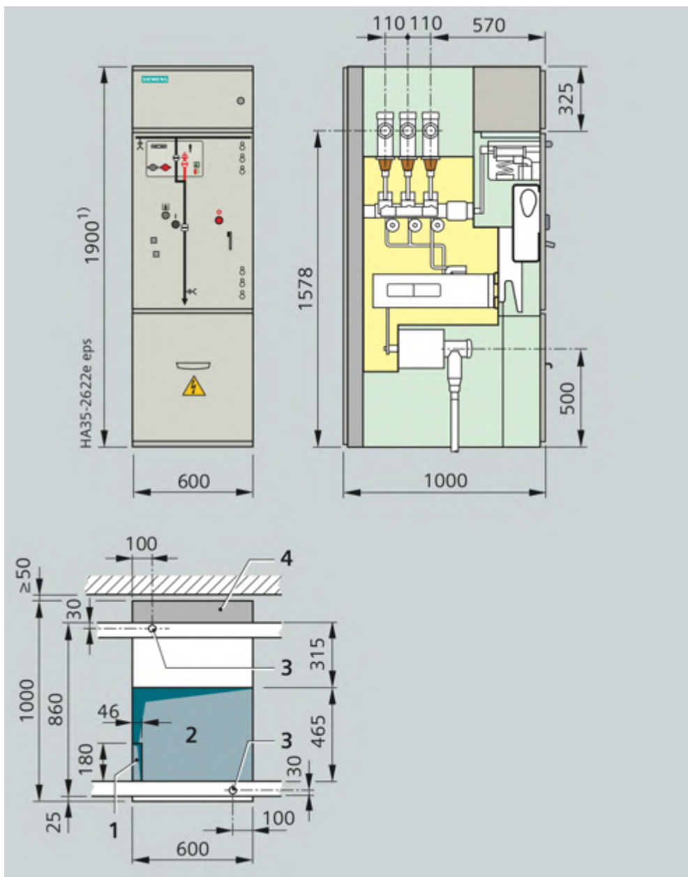
Figura 77. Celda de protección con interruptor automático de Siemens NXPLUS C Wind [69].
