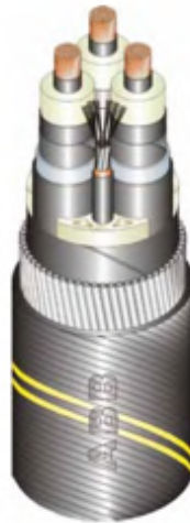
Figura 88. Cable tripolar de exportación de 200 kV de ABB [80].
