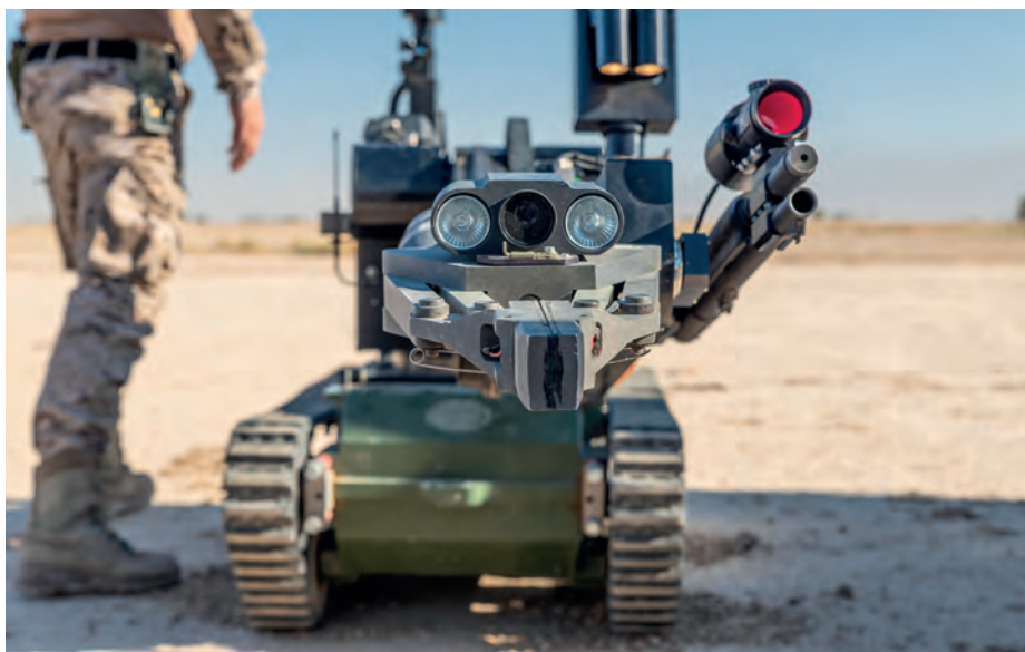
Robot de desactivación de explosivos empleado en las Fuerzas Armadas para la localización, identificación y manipulación de artefactos sospechosos.
