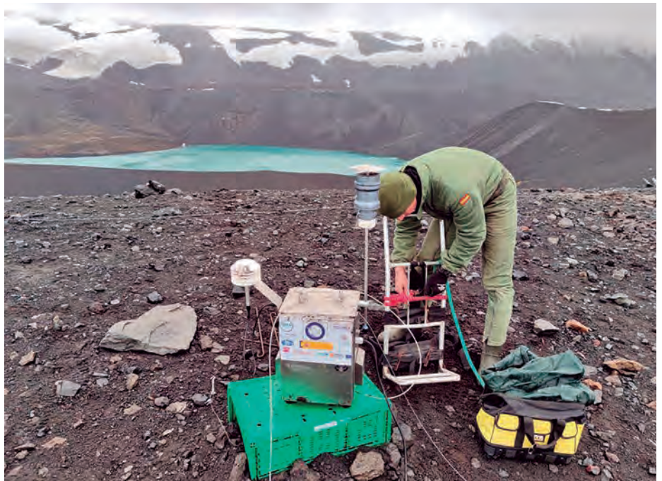
Instalación de una estación sísmica para analizar el estado geológico de la isla Decepción y verificar su nivel de actividad volcánica.
