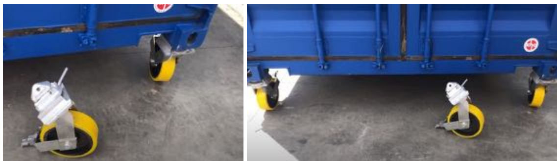
ILUSTRACIÓN 59. COLOCACIÓN DE TANQUETAS 71
