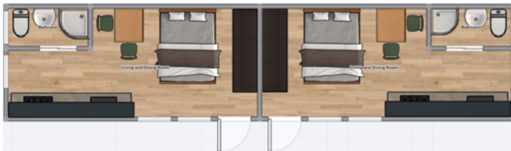
DISEÑO CONTENEDOR 40' CON DOS VIVIENDAS
