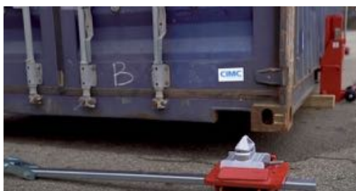
ILUSTRACIÓN 61. COLOCACIÓN DE TANQUETAS 75
