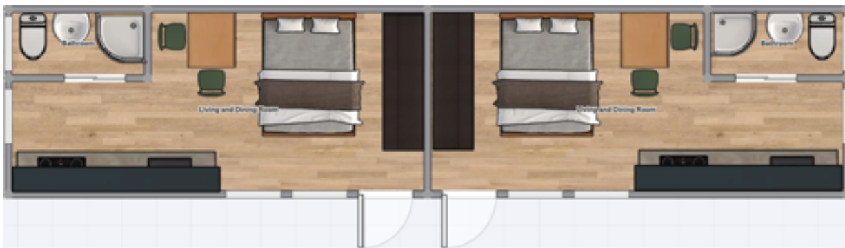
ILUSTRACIÓN 101. DISEÑO VIVIENDA UNIPERSONAL DOBLE CONTENEDOR DOBLE 40'
