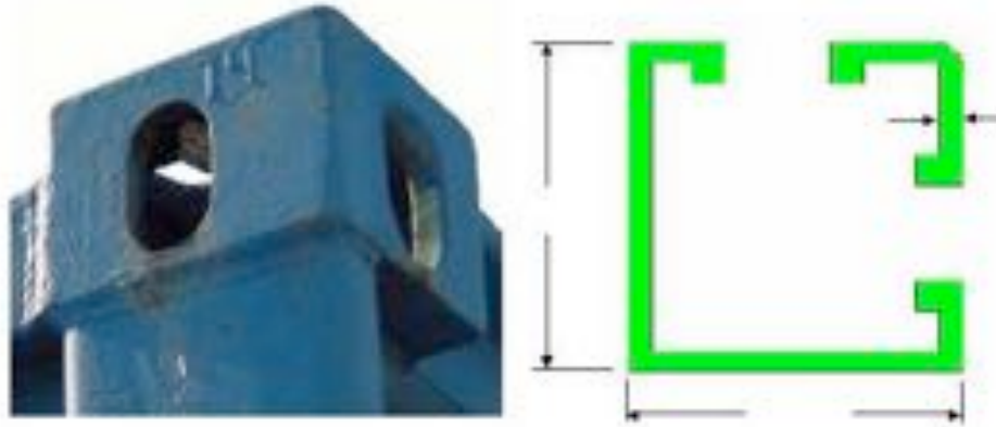
ILUSTRACIÓN 107. GEOMETRÍA DE LAS ESQUINAS DE REFUERZO DE LOS CONTENEDORES 143
