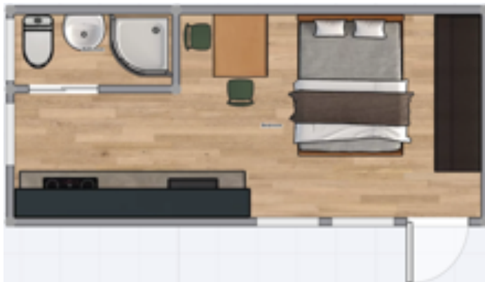
ILUSTRACIÓN 100. DISEÑO VIVIENDA UNIPERSONAL CONTENEDOR 20'
