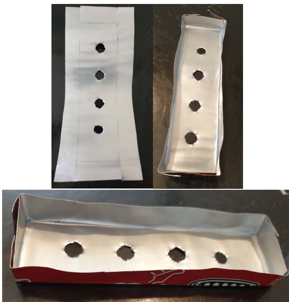
Fig. 62 Fabricación del molde con lata
