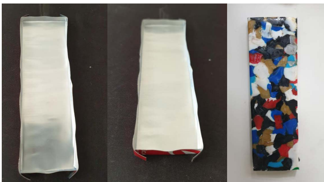
Fig. 69 Fabricación del molde y pieza acabada
