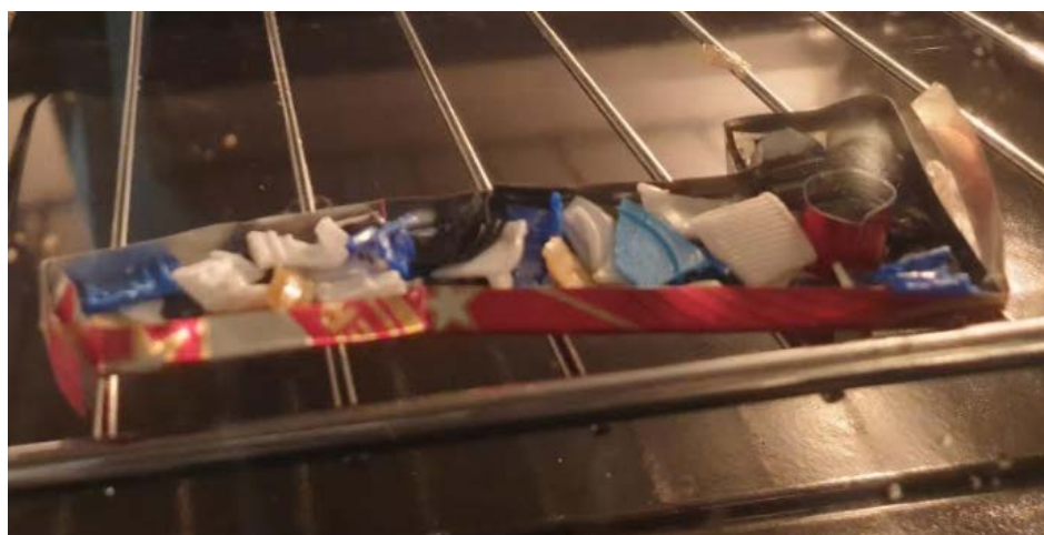
Fig. 38 Plástico fundiéndose en el molde
