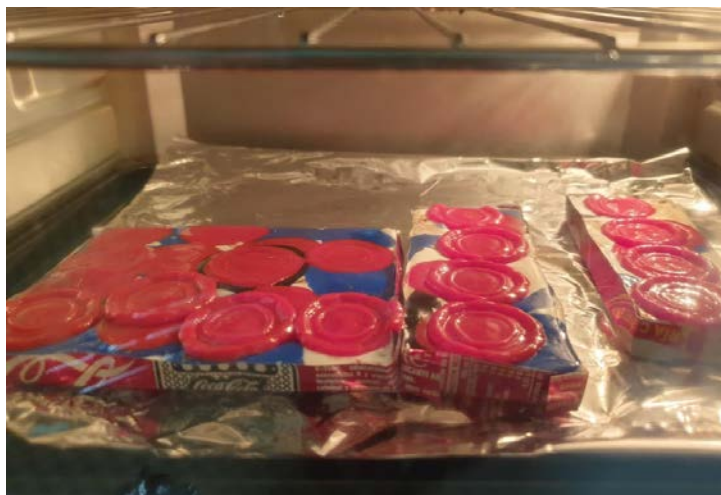
Fig. 76 Moldes con tapones enteros fundiéndose en el horno
