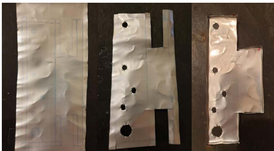
Fig. 55 Fabricación del molde con lata
