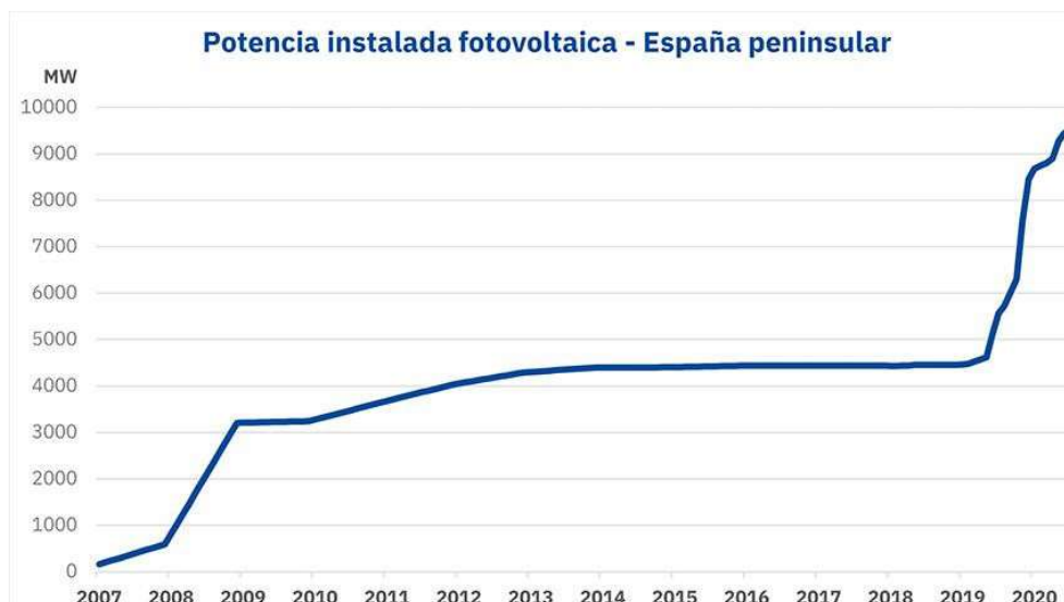
Figura 1. Evolución potencia solar fotovoltaica instalada en España peninsular (1).
