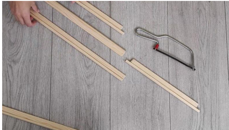
Figura 59. Corte de las maderas con una segueta
