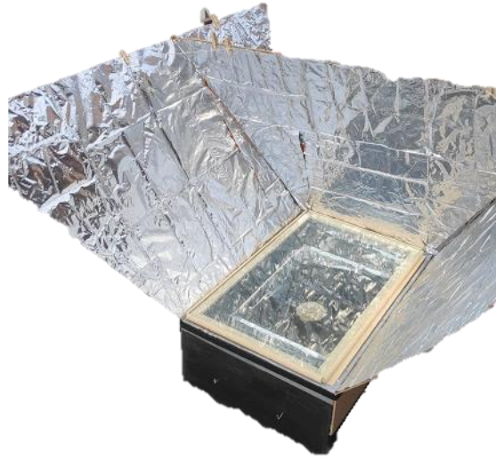
Figura 64. Horno solar con reflectores
