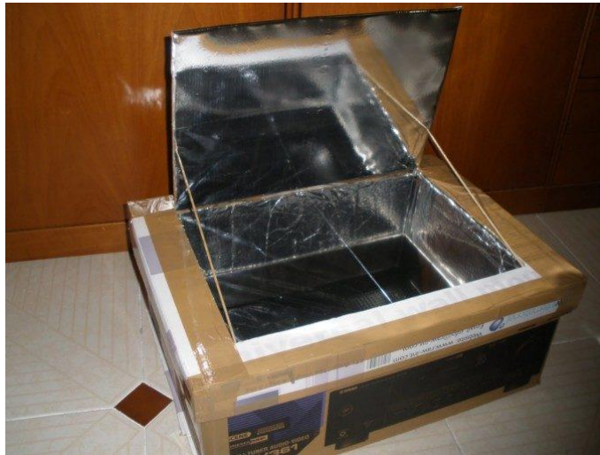
Figura 13. Interior reflectante con base negra de horno solar artesanal
