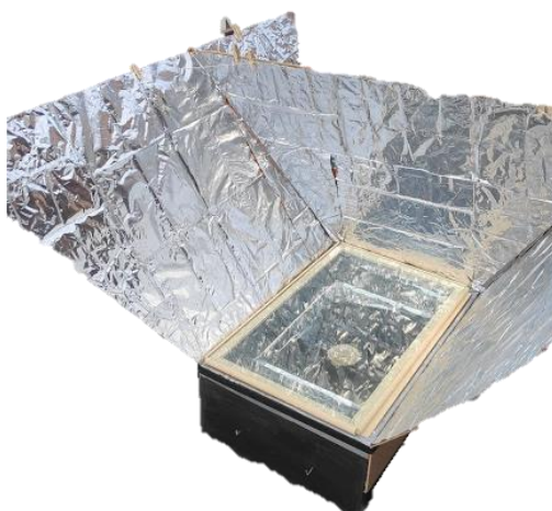
Figura 1. Prototipo de horno solar construido con materiales reciclados
