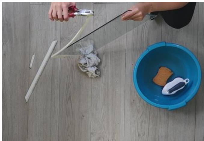
Figura 57. Desprendimiento de la cubierta de plástico del cristal de nevera
