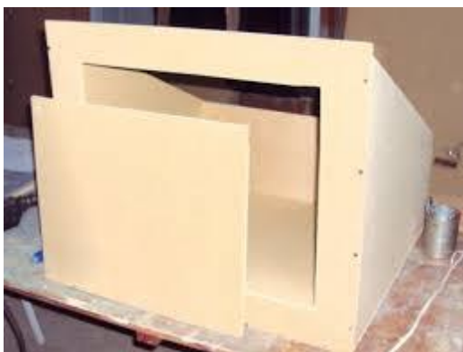
Figura 16. Puerta trasera de un horno en construcción
