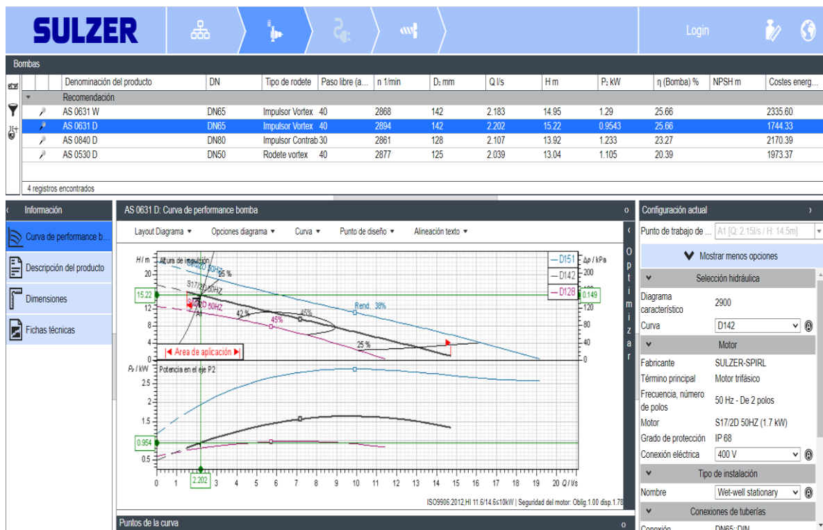
Ilustración 4. Selección de bombas en serie a través del software ABSEL. (Fuente: Elaboración propia mediante ABSEL Sulzer's Wastewater Pump Selection Tool)
