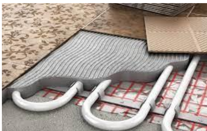
Ilustración 19. Instalación de los tubos hídricos del suelo radiante-refrescante. (Fuente: Instalaciones y eficiencia energética)
