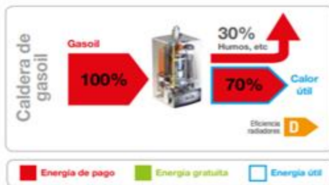
Ilustración 23. Calefacción por caldera de gasoil colectiva. (Fuente: Mitsubishi Electric)
