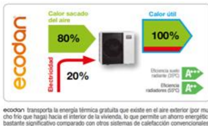
Ilustración 22. Calefacción por sistema ECODAN individualizado. (Fuente: Mitsubishi Electric)
