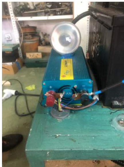
Figura 33: Inversor. Fuente: Elaboración propia
