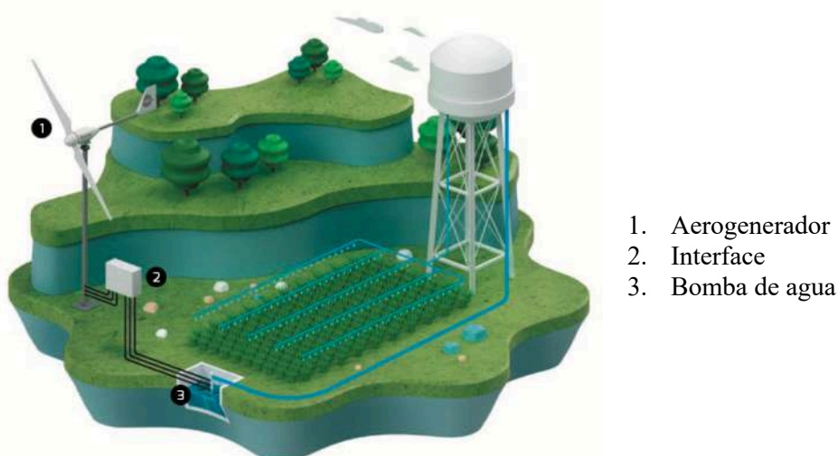
Figura 10.3 Conexión de aerogenerador con interfaz Wind+. Fuente: Catálogo de Bornay
