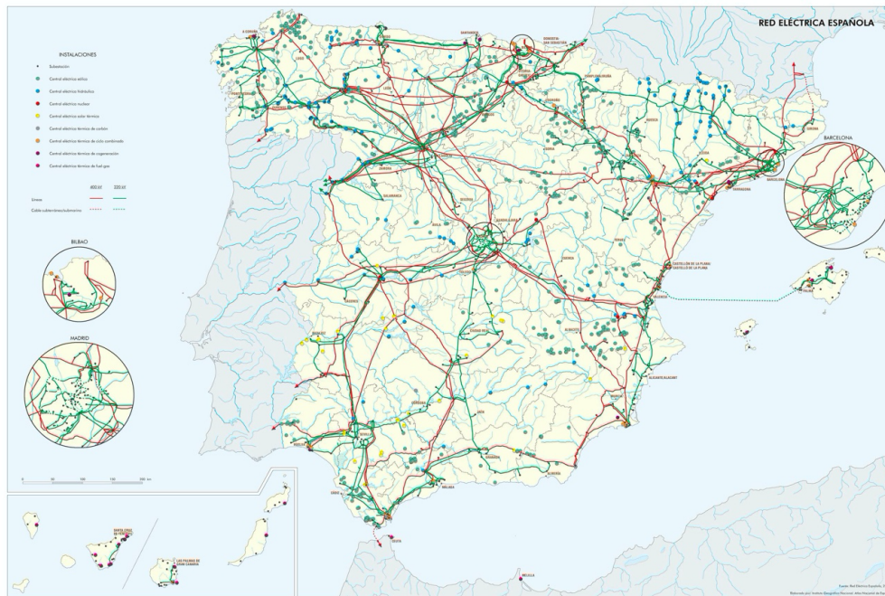
Figura 1 Mapa de líneas eléctricas de 220 y 400 kV en España
