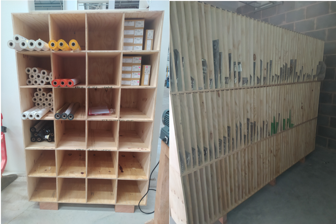
Ilustración 14: Estanterías fabricadas adaptadas al accesorio a almacenar
