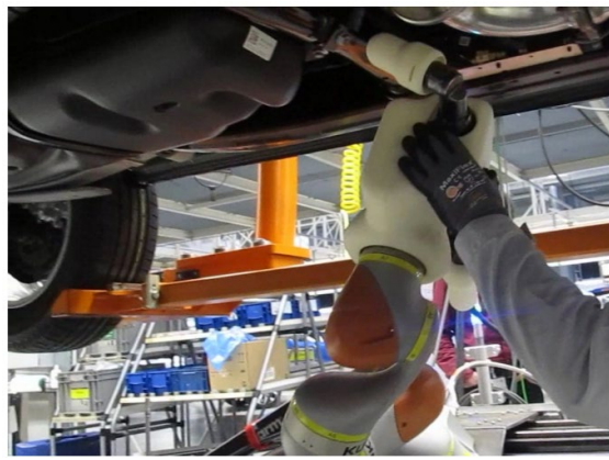
Ilustración 3-1. Robot KUKA LBR iiwa 14 R820 en fábrica de montaje Volkswagen [12]
