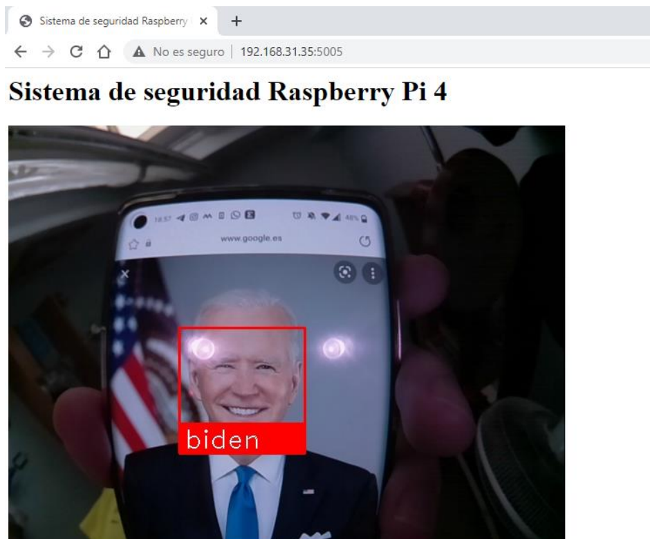
Ilustración 55: Interfaz de Flask con la detección de objetos activa
