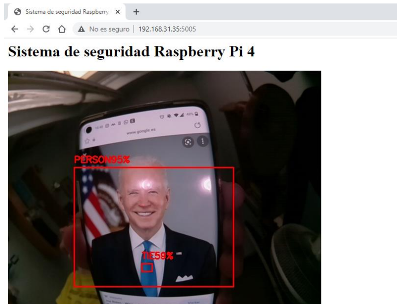
Ilustración 55: Interfaz de Flask con la detección de objetos activa
