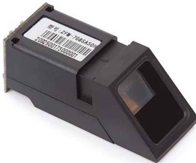
Ilustración 31: Lector de huellas ZFM-70 [35]
