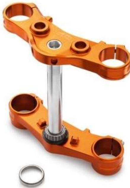
Figura 48: Tijas adquiridas con offset 20mm
