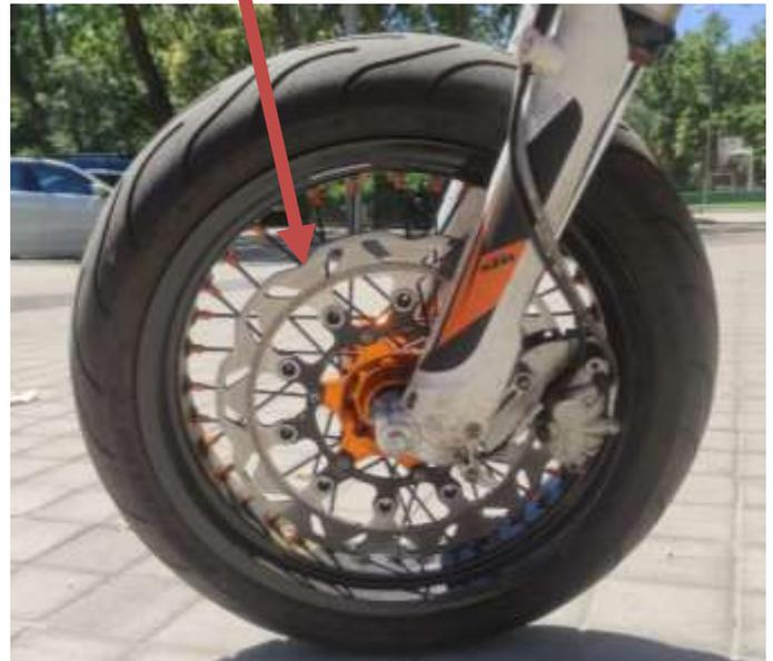
Figura 21: Disco de freno de Sm (310mm)
