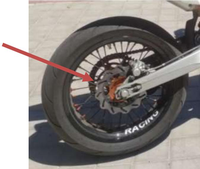
Figura 22: Disco de freno trasero de 220mm
