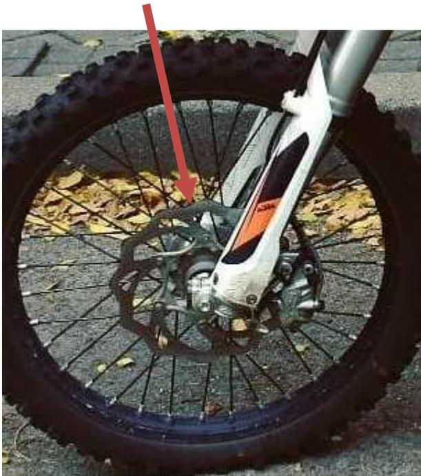
Figura 20: Disco de freno (260mm)
